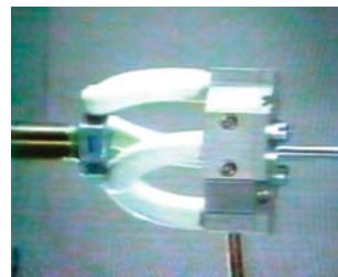
Obr.49 Štvorprstové chápadlo USA – MIT na báze umelých svalov s priemerom prstov 12 mm, otáčajúce skrutkou
