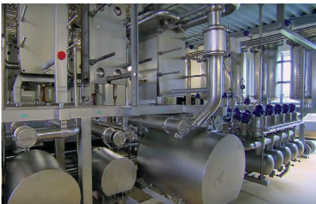
Takmer 300 čerpadiel Alfa Laval pomohlo zvýšiť výrobu a energetickú účinnosť výrobného procesu mozzarely v závode Arla Foods
