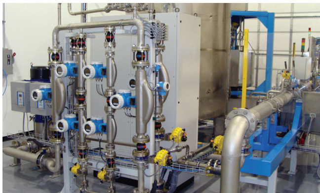
Obr. 3 Prietokomery sú kalibrované podľa platných noriem na certifikovaných kalibračných tratiach, ako je napr. táto, ktorá je umiestnená v kalibračnom laboratóriu spoločnosti Endress+Hauser v La Porte v Texase (USA) a akreditovaná americkou asociáciou A2LA podľa normy ISO/IEC 17025
