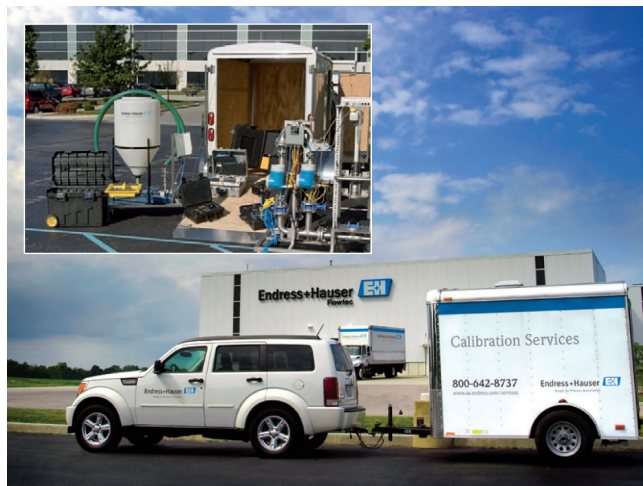
Obr. 4 Mobilná kalibračná trať na kalibráciu in-situ
