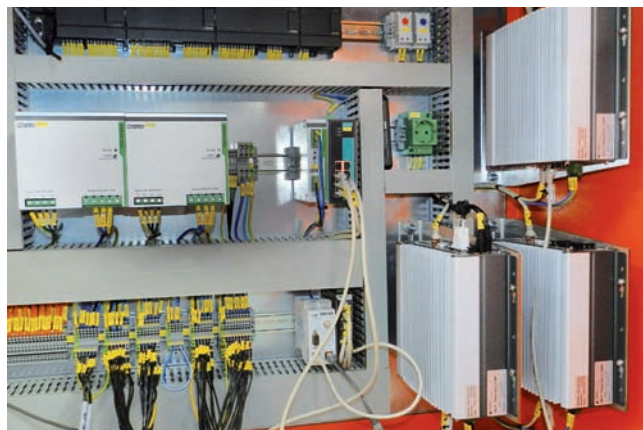
Dva zdroje TRIO POWER od Phoenix Contact (vľavo) spoľahlivo napájajú celú riadiacu elektroniku triediaceho stroja.
