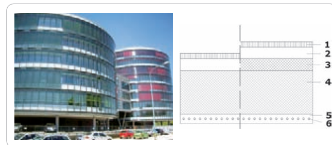
Obr. 2 Budova B. Vľavo pohľad na budovu, vpravo systém s kapilárnymi rohožami (1 – vrstvy podlahy, 2 – vyrovnávacia vrstva, 3 – akustická izolácia, 4 – nosná vrstva, 5 – rúrky, 6 – vrstva omietky)
