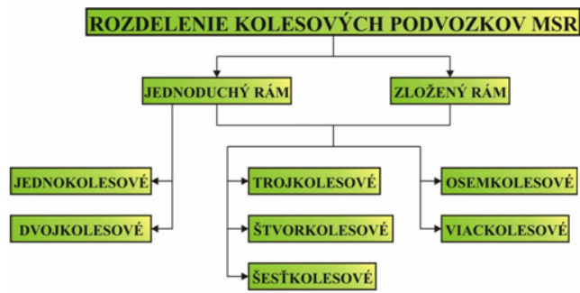
Obr.7 Rozdelenie kolesových podvozkov Fig.7 Distribution of flywheel undercarriages
