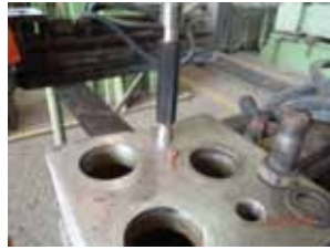
Obr. 3 Opatrenie závitov v telesa stienky, nesprávna podložka (plocha), krátka skrutka (iba 45 mm)
