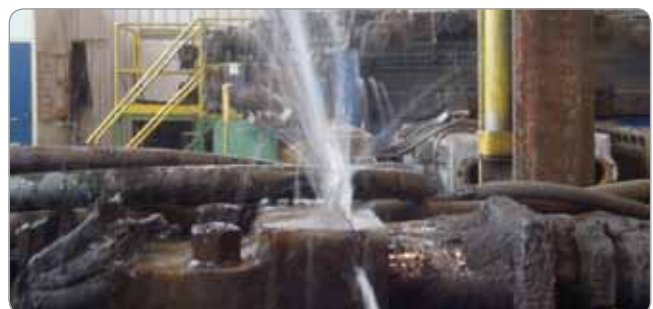
Obr. 2 Skúška chladiaceho okruhu – únik vody na chladiacom okruhu rámu bočnej stienky
