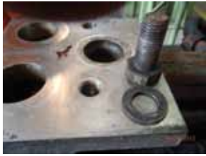
Obr. 3 Opatrenie závitov v telesa stienky, nesprávna podložka (plocha), krátka skrutka (iba 45 mm)
