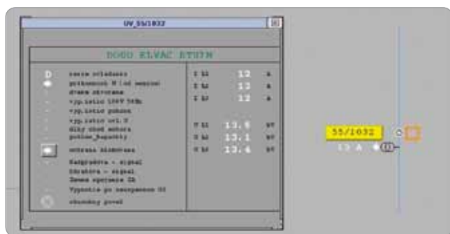
Obr. 5 Inteligentný, diaľkovo ovládaný úsečník v schéme RIS
