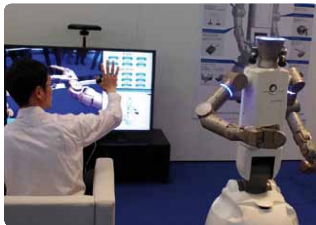
Obr. 7 Riadenie humanoida pomocou gest snímaných Kinectom
