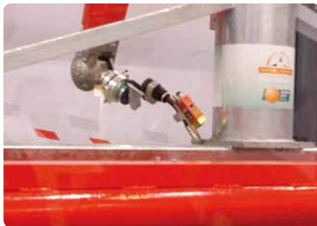
Obr. 4 Proces zvárania korigovaný pomocou laserového skenera
