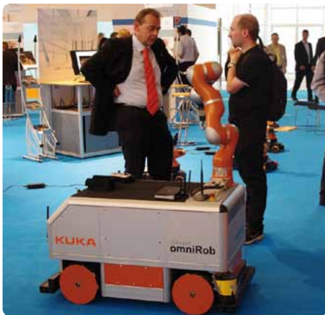
Obr. 5 Koncept všesmerového mobilného manipulátora KukaomniRob
