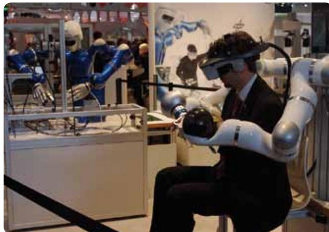
Obr. 3 Teleoperátorské haptické riadenie humanoidného robota Justin s vizuálnou a silovou spätnou väzbou
