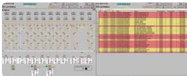
Obr. 4 Pohľad na obrazovky operátora – vizualizácia zariadení z poľa (vľavo) a tzv. poruchové hlásenia (vpravo)
