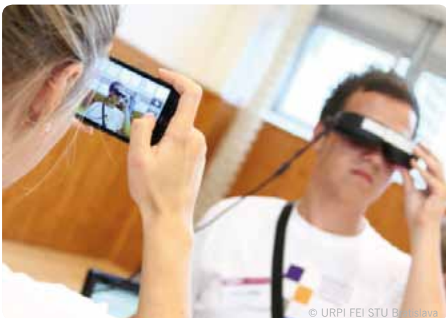
Obr. 6 Obraz z kamery umiestnenej na mobilnom robotovi sa bezdrôtovo prenáša do okuliarov.
