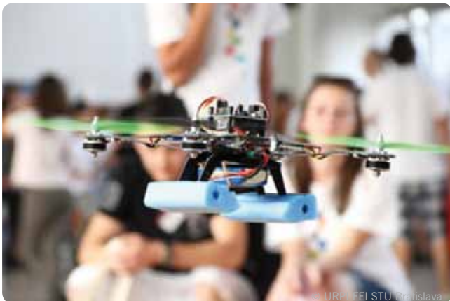
Obr. 4 Kvadroptéra využíva riadiaci systém a riadiace algoritmy navrhnuté študentmi študijných programov Robotika a Kybernetika.
