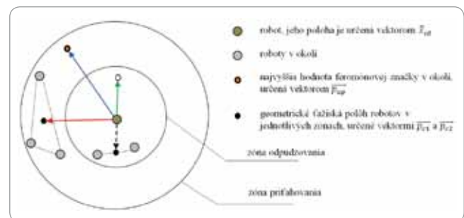
Obr. 1 Grafické znázornenie matematického princípu. Robot uprostred (hnedý bod) je odpudzovaný od dvoch robotov, ktoré sú v tzv. zóne odpudzovania (vnútorná kružnica), a priťahovaný k robotom, ktoré sú v zóne priťahovania (vonkajšia kružnica). Na výpočet týchto síl je použité geometrické ťažisko pozícií robotov v dvojrozmernom priestore (čierny bod medzi robotmi). Keďže robot sa má od robotov v zóne odpudzovania vzdalovať, k čiernemu vektoru je vypočítaný vektor opačný (zelený vektor). Modrý vektor určuje polohu najvyššej feromónovej značky v okolí robota, určujúcej najdlhšie nepreskúmaný bod jeho aktuálneho okolia.
