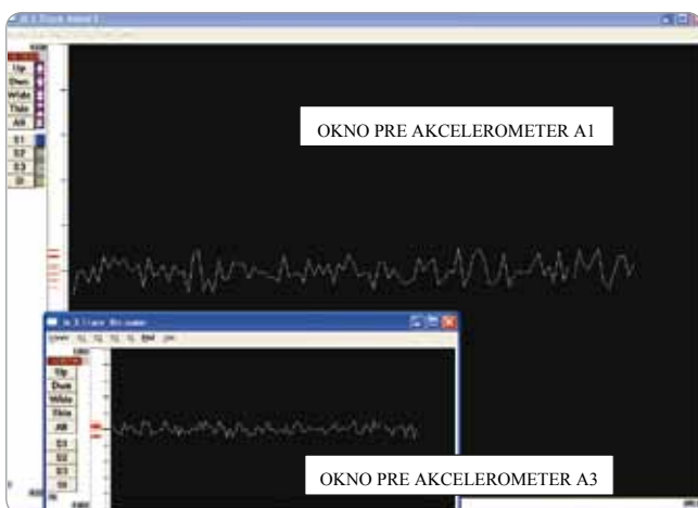
Obr. 5 Zaznamenanie vibrácií v programovom module ScopeWIN
