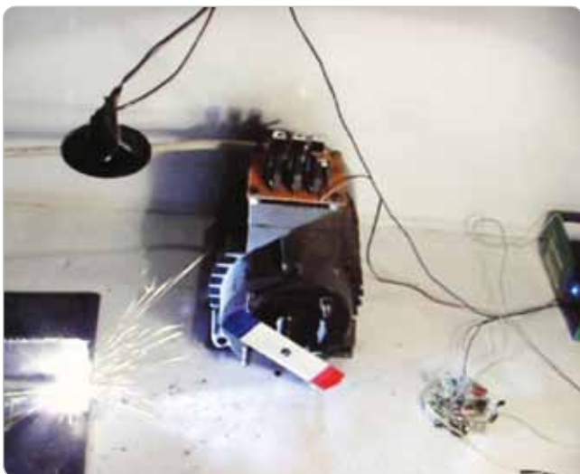
Obr. 5 Overenie funkčnosti – krátkodobé škrtnutie oblúka
