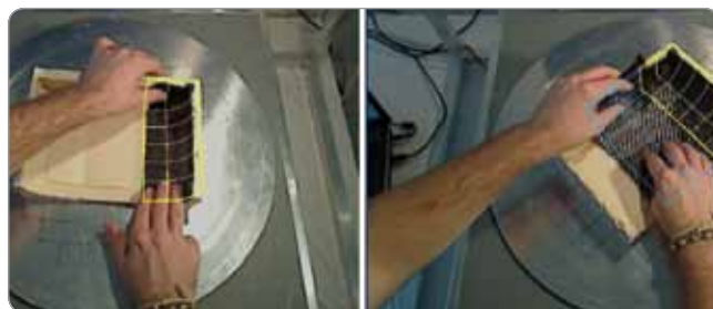
Obr. 14 Príklad montážneho procesu ručného kladenia vrstiev kompozitu na maticu
