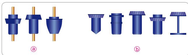
Obr. 49 Typy plavákov. a) stabilné, b) nestabilné
