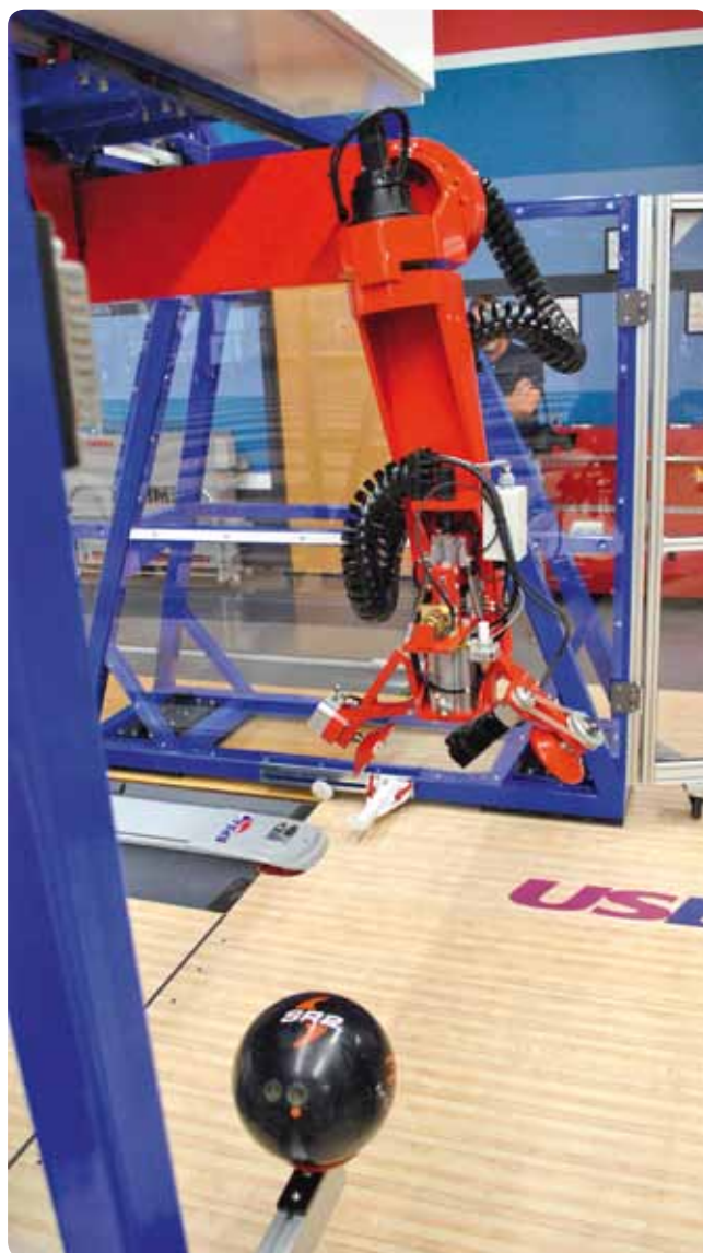
Pohybový aparát robota E.A.R.L. sa skladá z lineárnej osi, z päťosového polohového robota a z mechanizmu na rotáciu a vrhnutie gule
