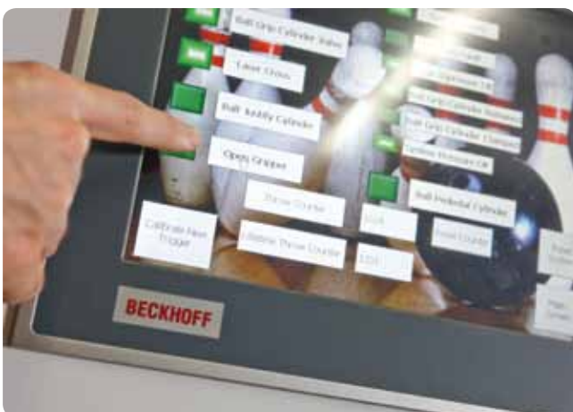
Testovacie nastavenia možno pohodlne zadávať na ovládacom paneli s 12-palcovým dotykovým displejom. Robot možno preprogramovať cez ovládací panel na kompletne iné parametre za menej ako 10 sekúnd
