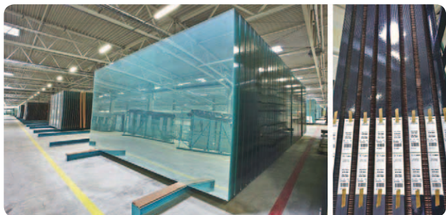
Obr. V záverečnej fáze prenášajú manipulačné roboty sklenené platne na transportné stojany.
