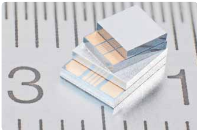
Obr. 4 S plochou len 8 mm 2 umožňujú micro-TEC dodávať na výstupe vysoké úrovne napätia.
