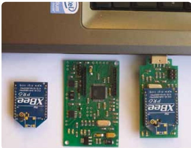
Obr. 2 Koordinátor WSN(USB) a prvok s funkciou akčného člena s komunikačným modulom
