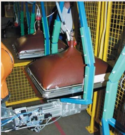
Okamih vloženia obrazovky do výstupného dopravníka
