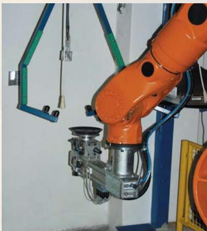
Čakanie pri vstupnom dopravníku. Uchopovacie zariadenie (greifer) s prísavkou.
