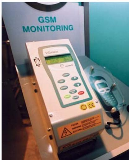
Frekvenčný menič typového radu VQFREM možno ovládať aj pomocou mobilnej siete
