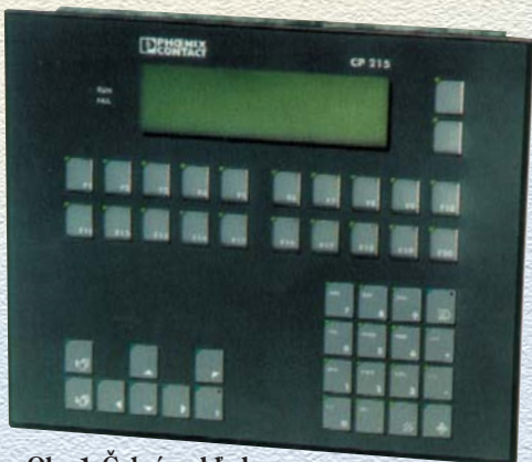
Obr.1 Čelný pohľad na operátorský panel CP 215
