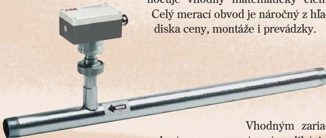
Vhodným zariadením pre spomínanú aplikáciu je tepelne vodivý hmotnostný prietokomer Sensyflow D. Princíp činnosti spočíva v meraní zmeny odporu meracieho článku v závislosti od rýchlosti a hustoty meraného média. Meranie je nezávislé od zmeny tlaku a teploty média.
