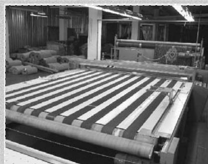
K modernizácii linky na potlačovanie syntetických kobercov, koncepčne i súčiastkovo navrhnutej na prelome 70. a 80. rokov minulého storočia, sa priklonil výrobca kobercov najmä z dôvodov potreby zvýšenia výrobných kapacít linky. Ďalším očakávaným prínosom tejto modernizácie je zvýšenie kvality potlače ako výsledok novej technológie nanášania farebného vzoru na polotovár koberca a spolupráca s novými pohonmi linky.
