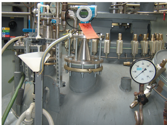
Obr.5 Micropilot M inštalovaný u farmaceutického výrobcu na Slovensku
