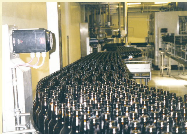
Obr.1 Moderné zariadenie na dopravu fliaš firmy KHS Dortmund, inštalované v Litve, s motormi a frekvenčnými meničmi FCM 300, inštalovanými na remeňový prevod. Výkony na hriadelí motora dosahujú 0,55 až 7,5 kW
