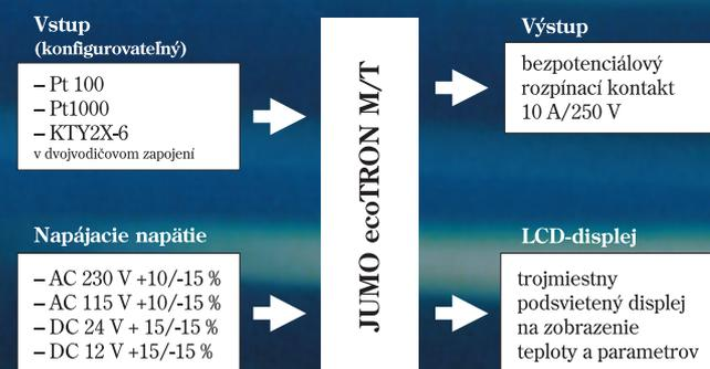
Nové elektronické termostaty radu JUMO ecoTRON M a T si nájdu široké uplatnenie v chladiacej, klimatizačnej technike a vzduchotechnike, ohrievacích, solárnych zariadeniach, tepelných čerpadlách, transformátoroch, ale aj v pekárenských peciach a priemyselných fritézach.
