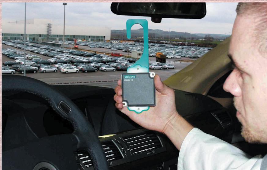
Princíp je podobný ako v prípade klasických systémov MOBY. Po parkovisku/parkovacom dome sú v istej definovanej vzdialenosti od seba rozmiestnené antény (ich minimálny počet je 4). Sieť antén je napojená na počítačový systém, ktorý je schopný zamerať hľadaný objekt s presnosťou 3 metrov.
