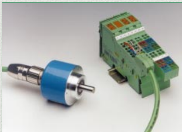
Obr.5 Svorkový modul Interbus Inline s možnosťou polohového riadenia až 100 osí
