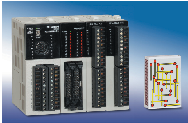
Miniaturizácia: uvedená zostava FX2NC má spolu 24 dig. vstupov, 56 dig. výstupov a veľkosť: 105,6 × 90 × 74 mm (š × v × h)
