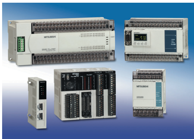
V súčasnosti predávané kompaktné automaty Mitsubishi Electric. Zľava, najprv horný rad: MELSEC FX2N, FX1N (s doplneným portom RS 232 a displejom), ethernetový modul, FX2NC, FX1S
