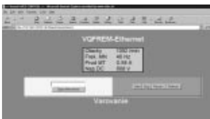
Obr.8 Príklad výslednej webstránky s aktuálnymi nameranými veličinami. IP adresa servera je 192.168.0.2
