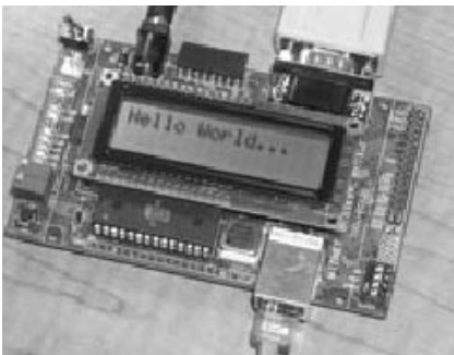
Obr.5 Realizovaný miniatúrny webový server
