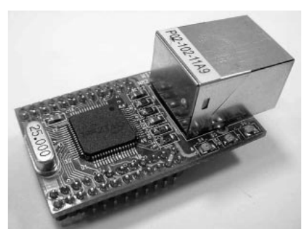
Obr.3 Komunikačný modul IIM 7010 na pripojenie vstavaných aplikácií k internetu
