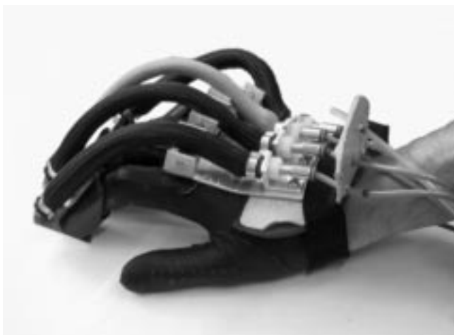
Obr.7 Haptická rukavice s pneumatickými svaly
