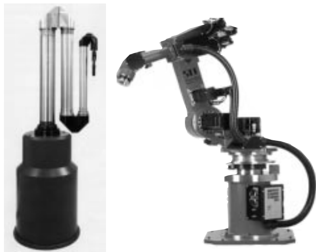
Obr.1 Robot s motory v základním rámu (vlevo) a s hybridní koncepcí motorů (vpravo)
