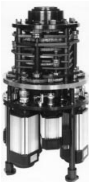
Obr.3 Motorová a převodová sekce robotu z obr. 2
