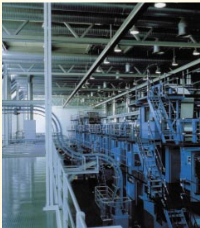
Obr.5 Osvetlenie vysokej haly rotačne symetrickými svetidlami
