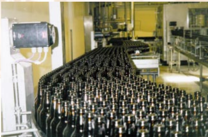
Obr.1 Moderné zariadenie na dopravu fliaš firmy KHS Dortmund, inštalované v Litve, s motorovými meničmi FCM 300 inštalovanými na remeňový prevod. Výkony na hriadelí motora sú v rozsahu 0,55 až 7,5 kW
