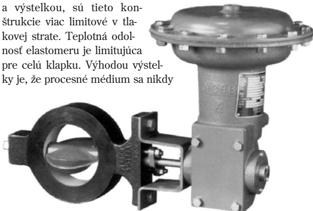
Obr.4 Plne prietocná disková klapka ponúka ekonomické riešenie pre škrtiace aplikácie s veľkým prietokom, avšak vzhľadom na chýbajúce tesnenie je jej nevýhodou vyššia netesnosť ako pri ostatných typoch
