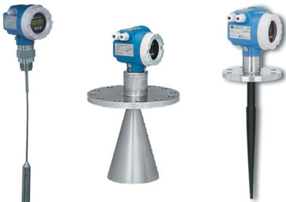
Dvojvodičová technika šetrí kabeľáž a umožňuje jednoduché napojenie do jestvujúcich systémov. Jednoduché uvedenie do prevádzky a prehľadnú diagnostiku zabezpečuje bezplatný softvérový balík ToF Tool. Výstupný signál môže byť analógový alebo digitálny (HART, PROFIBUS PA, Foundation Fieldbus). Snímače typového radu Micropilot a Levelflex sú vhodné pre procesné tlaky do 160 barov a teploty až do +400 °C.
