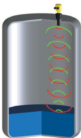
Obr.1 Princíp merania výšky hladiny pomocou ultrazvukových snímačov
