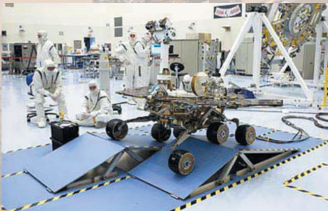
Výskumné vozidlo, ktoré začiatkom roka začalo výskum planéty Mars, používa základné formy behaviorálneho riadenia, aby zvládlo všetky úlohy autonómne
