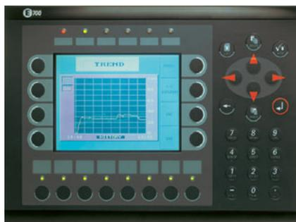
**MAC E710** – terminál ponúka dotykový 256-farebný displej s osemicou programovateľných klávesov, dva sloty na pripojenie rozširujúcich modulov a komunikačnej podpory, ako aj priame prepojenie s PLC a tlačiarňou.
