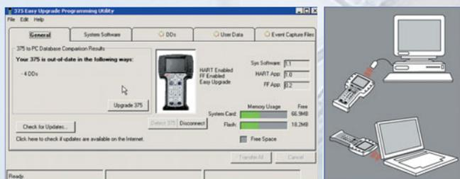
užívateľ prístroja ich jednoduchým spôsobom môže nahradiť do komunikátora. Podobne je možné aktualizovať operačný systém samotného komunikátora. Iskravobezpečné vyhotovenie umožňuje prácu v priestoroch s nebezpečenstvom výbuchu. Komunikátor 375 je kompatibilný s programom AMS, ktorý sa stal štandardom pre správu prevádzkových prístrojov v podnikoch.
