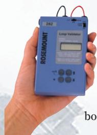
Na rýchlu kontrolu prúdových okruhov 4 až 20 mA je určený malý prenosný prístroj model 282. Kalibrátor umožňuje automaticky počas jednej minúty priebežne napájať prúdovú slučku v definovaných prúdových hodnotách. Pre kontrolu dvojvodičových prevodníkov je možné využiť meranie prúdu alebo % rozsahu.
