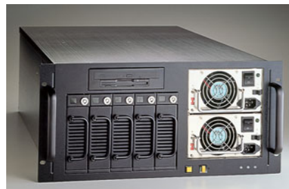
Obr.5 Šasi Advantech SPC-530 s integrovaným diskovým polom RAID
