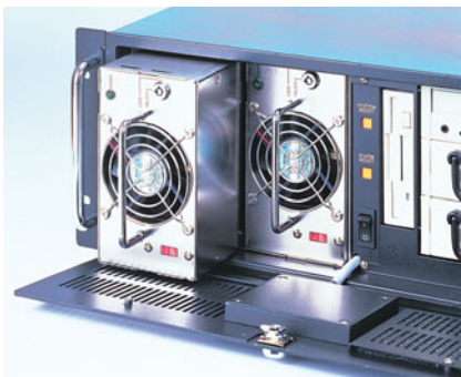
Obr.4 Zdroje redundantnej napájacej jednotky možno vymieňať počas prevádzky
