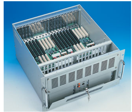
Obr.6 Pasívna doska zbernice v šasi priemyselného počítača Advantech
