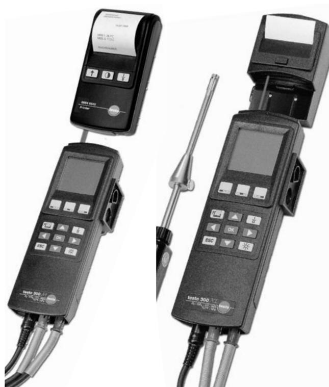
Obr.1 Prenosné analyzátory testo 300 M/XL
