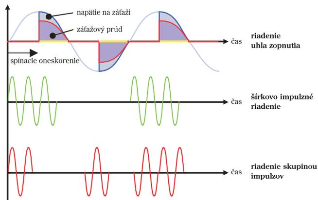
Existuje niekoľko typov foriem výstupných priebehov v závislosti od technológie: riadenie uhla zopnutia, šírkovo impulzné riadenie a riadenie skupinou impulzov.
