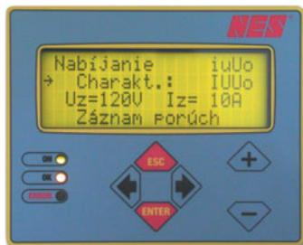
Na displeji modulu je zobrazovaný celkový výstupný prúd, výstupné napätie, prúd batérie, napätie batérie, poruchové hlásenia, charakteristiky nabíjania, náboj a pod.
