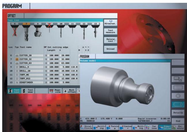
Skutočný tvar programovanej súčiastky je možné zobraziť v rovinnej simulácii, resp. v 3D simulácii pri rôznych pohľadoch, rezoch a zväčšeniach. Po ukončení simulácie je samozrejmosťou zobrazenie skutočného času obrábania aj s vedľajšími technologickými časmi, ako je napr. rozbeh a dobeh vretena, výmena nástroja atď.
