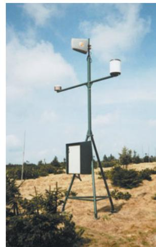
**Obr.3** Telemetrická měřicí stanice
