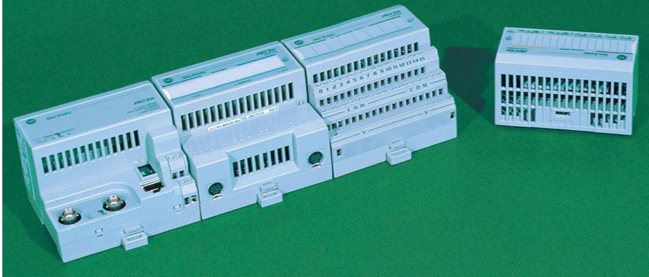
Flex I/O je kompaktný, modulárny systém vstupov, výstupov a nadväzujúcich zariadení, napríklad svorkovnic či komunikačných modulov. Originálna konštrukcia kombinujúca moduly vstupov a výstupov so svorkovnicami a komunikačnými modulmi do jedného bloku šetrí nielen náklady na pripojenie, ale aj miesto v rozvádzači. Znižuje tiež náklady na inštaláciu a opravy tým, že odstraňuje prepojavacie vodiče medzi jednotkami vstupov a výstupov a svorkovnicami.
