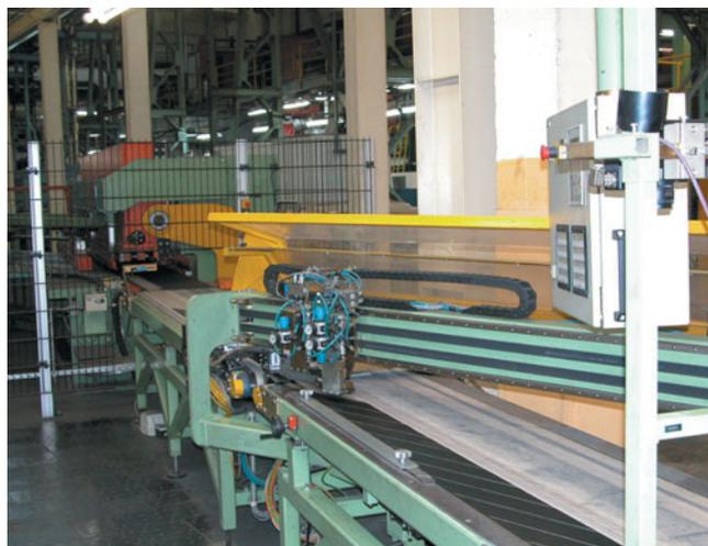
Najnovšia sekcia linka ocelokordu SLO č. 4 z Konštrukty Trenčín – záber na automatické spojovacie zariadenie nasekaných nárazníkov (prevádzka prípravy polotovarov)
