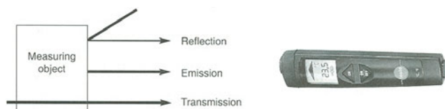
Obr.1 Princíp merania pomocou IR teplomera
